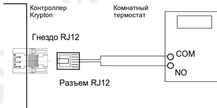
Подключение комнатного термостата имеющего **только** гнезда COM и NC.
