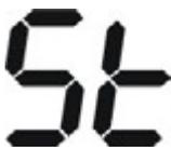
При переходе в дежурный режим на табло мигает надпись «**St**». Насос работает, пока вода не остынет до температуры выключения насоса. Proton может вернуться к режиму управления (розжига), если температура котла повысится на 5 °С от значения температуры выключения блока управления.
